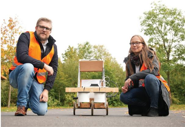
**Ilmsens Ultra-Breitband-Schichtdickenradar für Asphalt-schichtdicken-Messungen**
